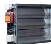
YBK-C Утепленный воздушный клапан. Корпус клапана изготовлен из стального листа, лопатки из алюминиевого профиля Имеет саморегулирующий нагревательный кабель периметрального нагрева
