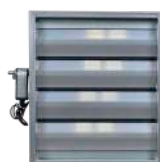
YBK-5 Воздушный клапан прямоугольный усиленный Корпус клапана изготовлен из стального листа, лопатки из алюминиевого профиля с резиновым уплотнением Симметричное открытие лопаток
